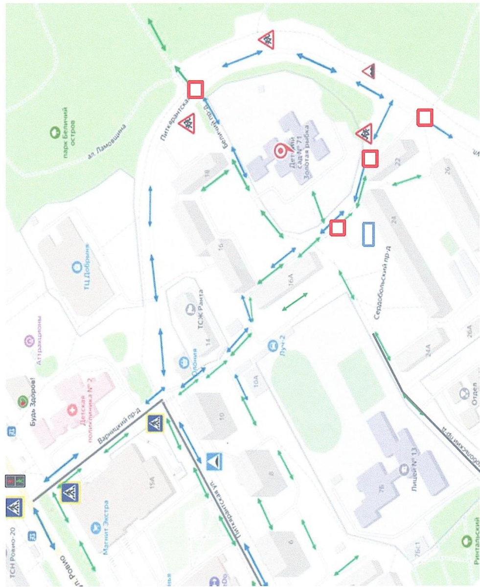
2. Схема организации дорожного движения в непосредственной близости от образовательной организации с размещением соответствующих технических средств организации дорожного движения, маршрутов движения детей и расположения парковочных мест.
